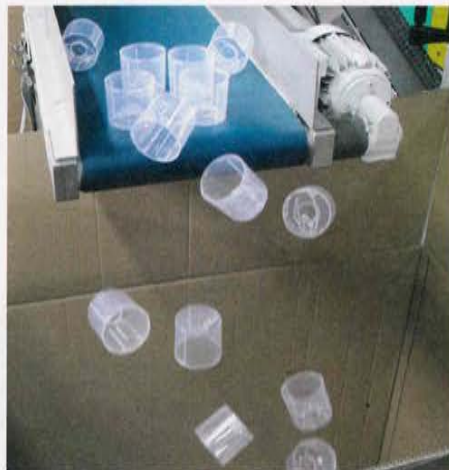
Teil der Kwasny-Produktion: Die Dosenkappen in der Kunststoffspritzerei
